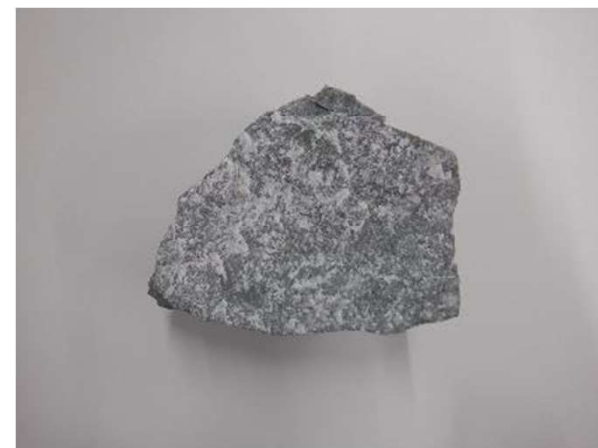
トンネル発生土(マイロナイト)
